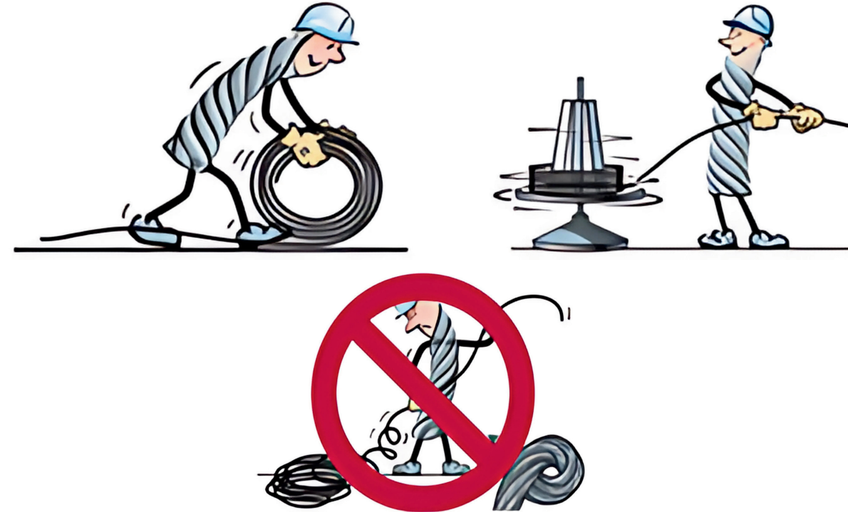
ROZWIJANIE LINY STALOWEJ
