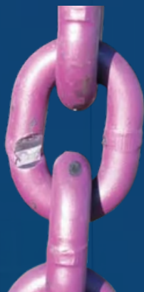
Nacięcia, ubytki, pęknięcia.
