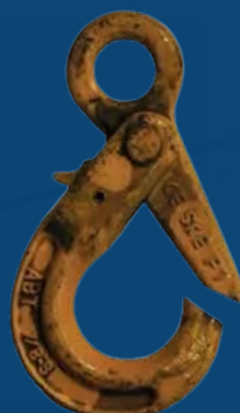
Zużyty zatrzask, hak nie zamyka się poprawnie.
