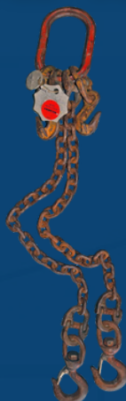
Zardzewiałe elementy zawiesi.
