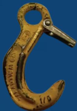
Przebiegniowe odkształcenie haka.
