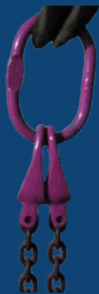
Oznaczenie jest nieczytelne. Brakująca tabliczka znamionowa.
