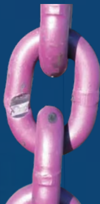
Nacięcia, ubytki, pęknięcia.
