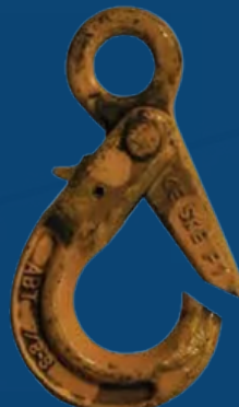
Zużyty zatrzask, hak nie zamyka się poprawnie.
