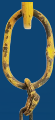
Odkształcenie spowodowane przebiegniem.
