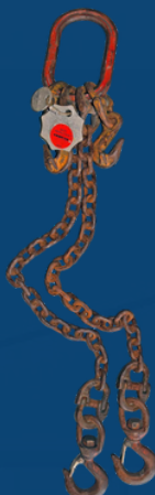
Zardzewiałe elementy zawiesi.
